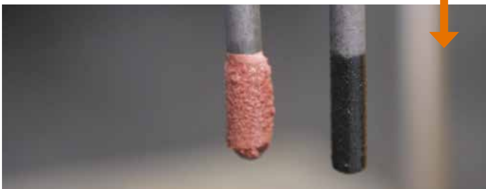
Og endelig det rene kobber på elektroden til venstre!
